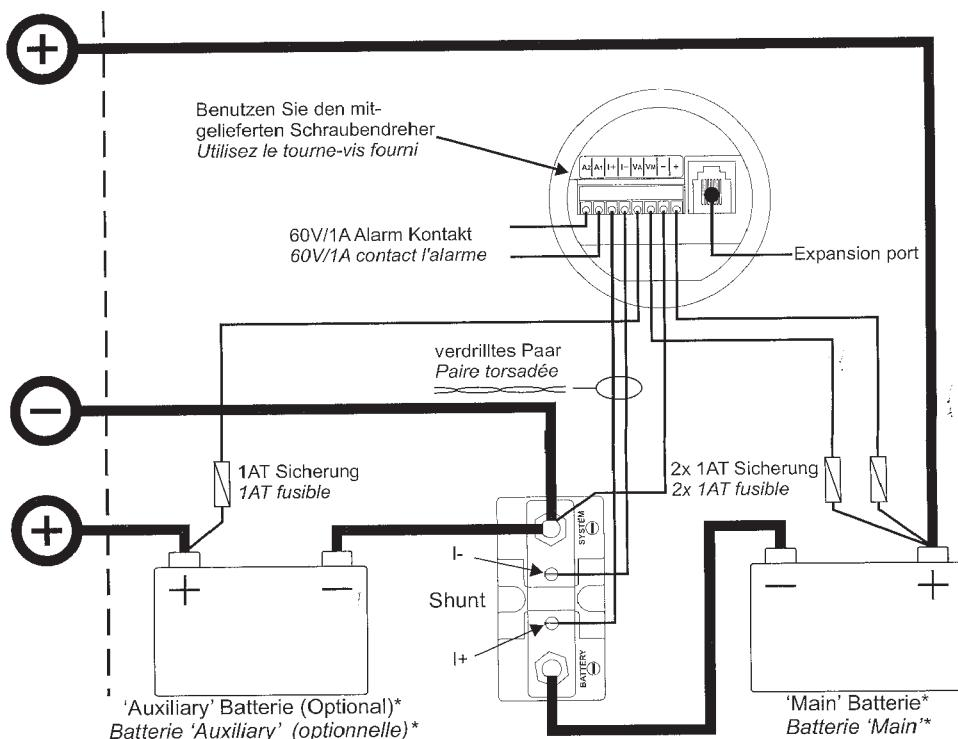
**WANUNG** Der Shunt muß immer in die negative Hauptversorgungsleitung angebracht werden. Das Anbringen des Shunts in die positive Leitung kann den Batterie Monitor beschädigen!
