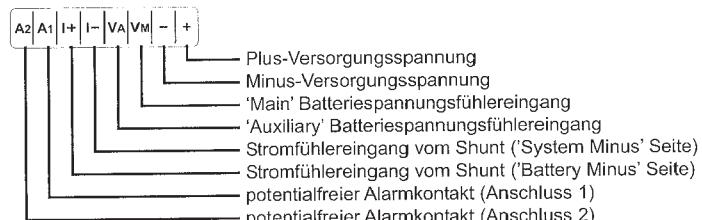
**AVERTISSEMENT** Le Shunt doit toujours être installé sur le négatif ( câble noir !) ! Installer le Shunt sur le positif ( câble rouge ), endommagerait le contrôleur de batterie!
